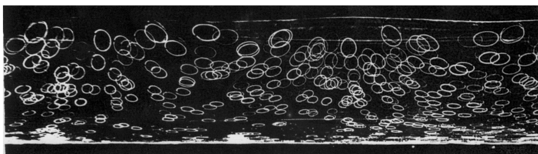
Рис. 45. Траектории частиц в частично стоячей волне ( R = 0.24 )
