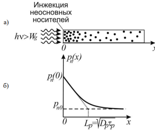
Рис. 3: Стационарная инжекция с одной стороны образца.
